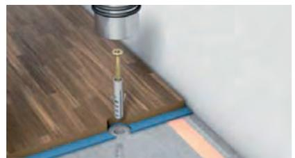
**BODEN** Dieses Beispiel zeigt eine schwimmende Verlegung unter Laminat/ Parkett. **E-ENERGY CARBON** ist mit nahezu allen Belägen kombinierbar. Auch hier gilt: nachträgliches Durchbohren (z. B. für einen Türstopper) ist völlig unproblematisch.
